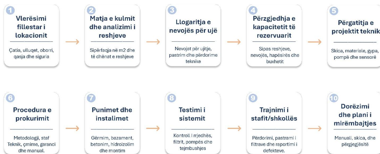
Figura 1: Procesi hap pas hapi i zbatimit të sistemit të grumbullimit të ujit të shiut
